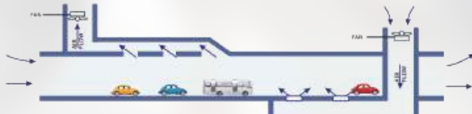
۱۰- سیستم تمام عرضی Transverse ventilation system
